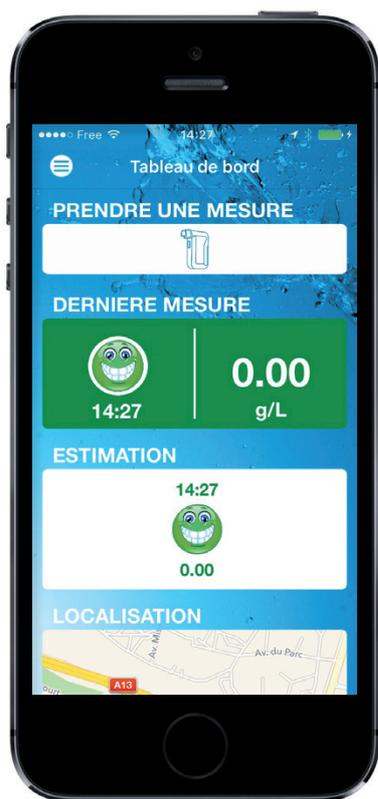
Elle s'opère par le biais d'un éthylotest avec capteur électrochimique dernière génération. Connecté par Bluetooth au smartphone, il permet de recueillir la **mesure précise** du taux d'alcool de l'utilisateur.
